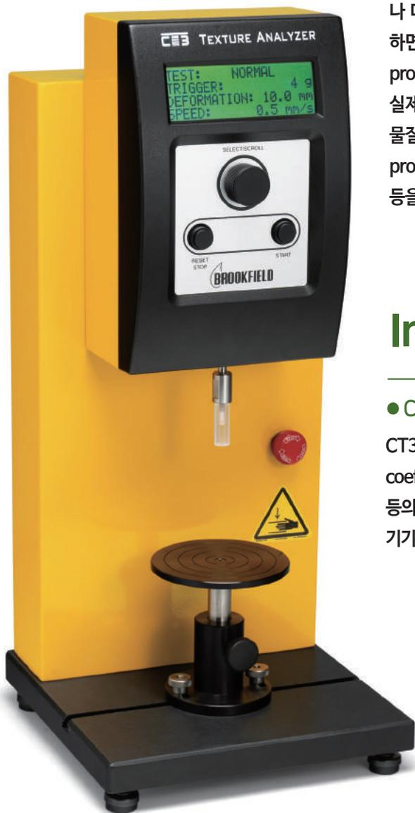
CT3 Texture analyzer는 8개의 테스트 모드와 다양한 악세서리의 사용으로 컴퓨터나 다른 소프트웨어 없이 기기 자체만으로도 물성 측정이 가능하고, 소프트웨어를 이용하면 보다 편리하고 효율적으로 data 분석과 그래프를 실시간으로 확인할 수 있습니다. probe를 통한 compression forces와 grip을 통한 tension forces를 이용하여 시료의 실제적인 성질과 관련되어 있는 강도, 점착성, 분쇄, 응집력, 농도, 씹는 정도 등 다양한 물질의 물리적 성질을 정확하고 재현성 있게 측정 할 수 있으며 시료의 특성에 따라서는 probe 선택, 악세서리 장착, probe의 스피드 조절(probe up down), 침투 거리 조절 등을 통하여 다양한 시료의 물성 평가에 응용될 수 있는 장치입니다.
